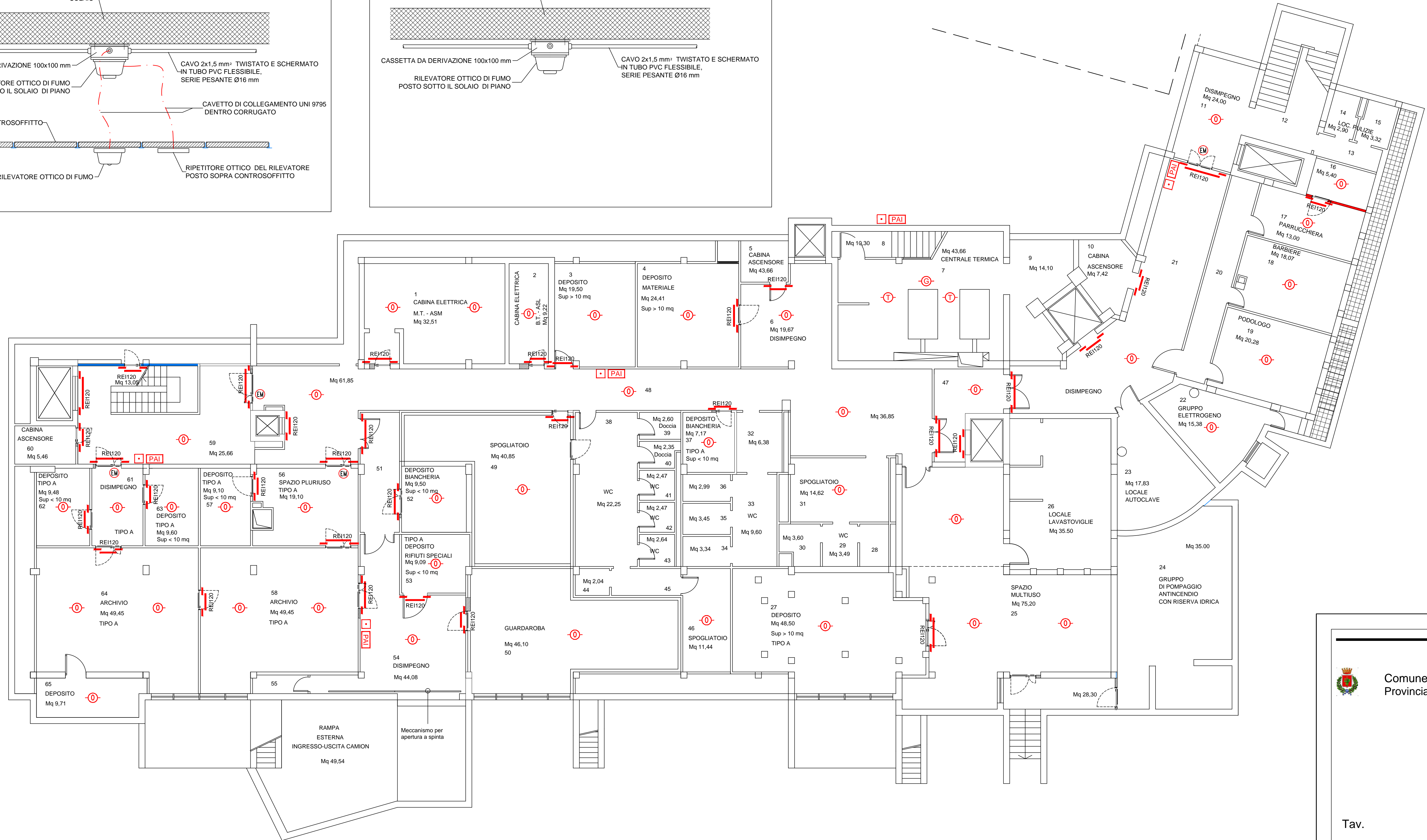
TIPICO RILEVATORI INCENDIO SOPRA CONTROSOFFITTO IN VERSIONE DOPPIA
